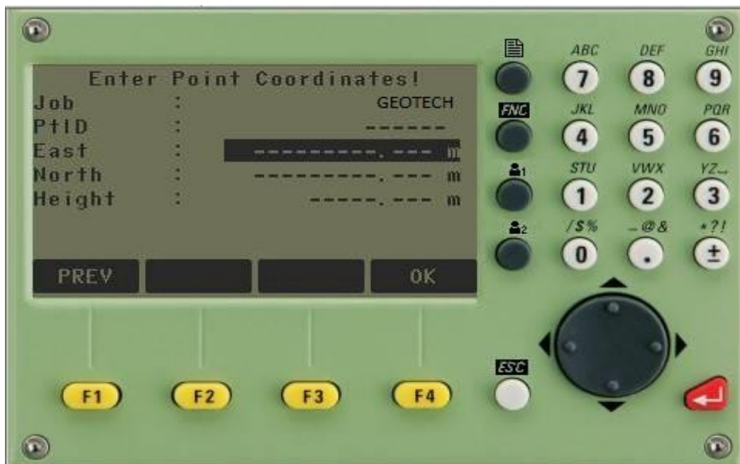
Hình 11: Nhập tọa độ điểm đặt máy
