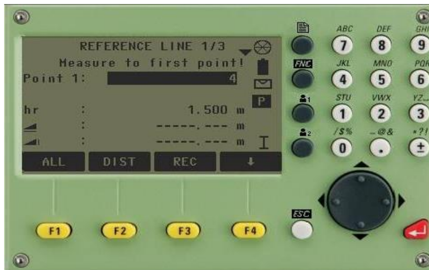
Hình 31: Tiến hành tạo đường chuẩn Baseline
