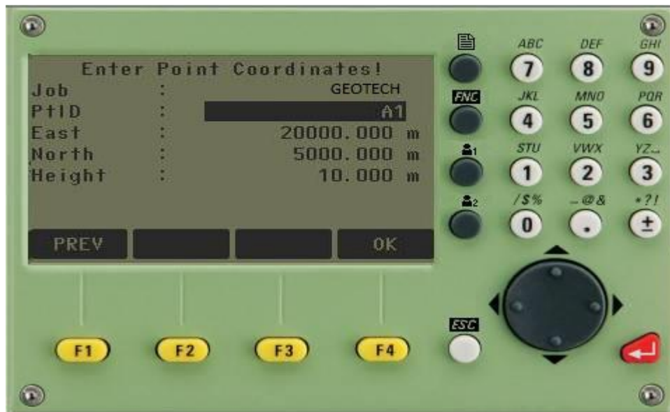
Hình 6: Giao diện nhập điểm trạm máy
