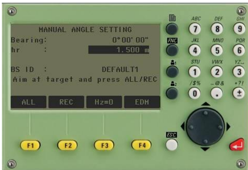
Hình 9: Định hướng bằng cách nhập góc
