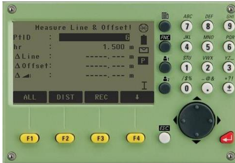
Hình 34: Đo kiểm tra vị trí điểm định vị
