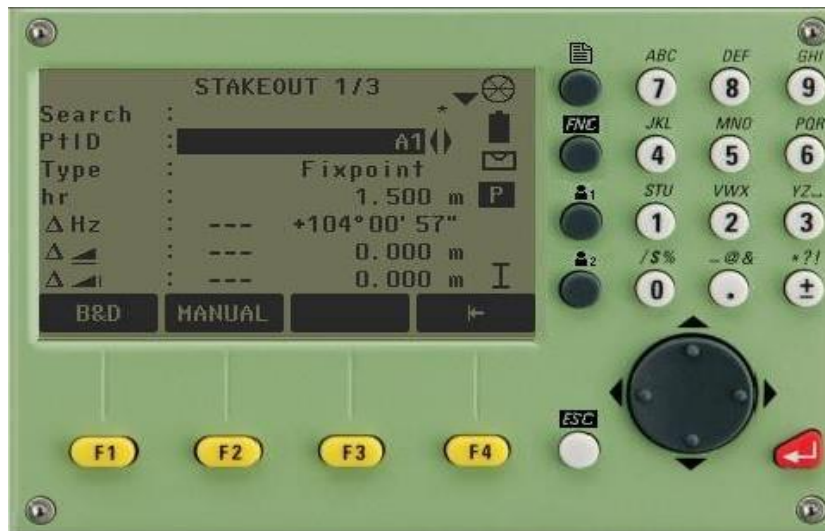
Hình 22: Chọn điểm cần STAKEOUT
