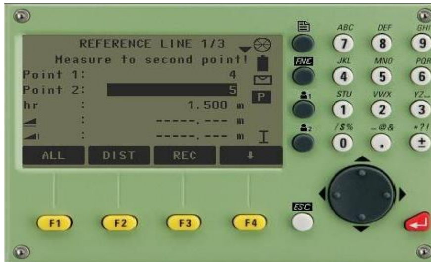
Hình 32: Tạo đường chuẩn
