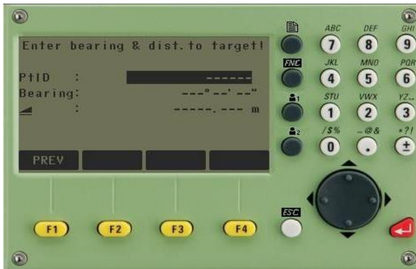
Hình 23: Nhập giá trị điểm STAKEOUT
