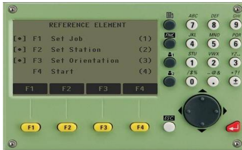
Hình 30 Thiết lập chế độ REFERENCE ELEMENT
